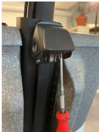
1.2 Schroef de slotkap aan de onderkant los met een Torx schroevendraaier.
