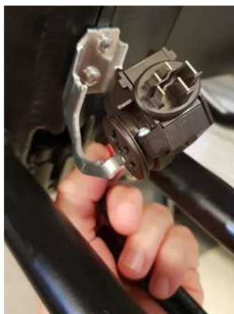
2.3 Om de connector uit de beugel te halen moet de connector kabel wat meer ruimte krijgen. Haal daarom eerst de kap van de motor los en vervolgens de kabel bij de motor los. Deze kan je nu wat doorvoeren. Druk vervolgens de connector uit de aluminium beugel.
